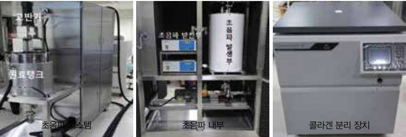
콜라겐 추출을 위한 산업용 초음파 시스템
